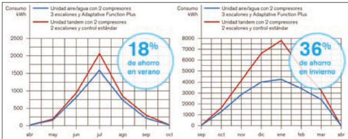
↑ Figura 5. Análisis efectuado para un edificio con oficinas en la ciudad de Milán, comparando el funcionamiento de una bomba de calor reversible con dos compresores trabajando con control tradicional y punto de consigna fijo (7 °C en verano y 45 °C en Invierno) y una unidad con tres etapas de parcialización, AF+ y punto de consigna variable (rango entre 7-14 °C en verano y entre 35 °C y 45 °C en invierno)
