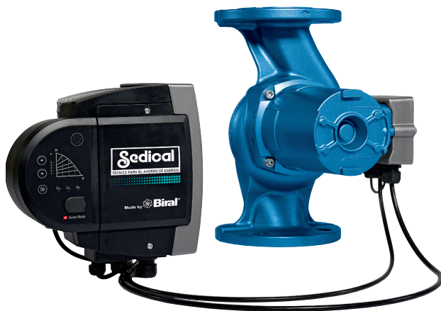
Na ModulA...GREEN para refrigeração monta-se o variador de frequência em separado. Evita a formação de condensações na parte eletrónica e garante um funcionamento fiável e um longo tempo de vida útil.
