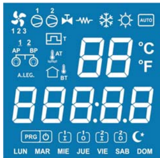
Display LCD con backlight de LED
