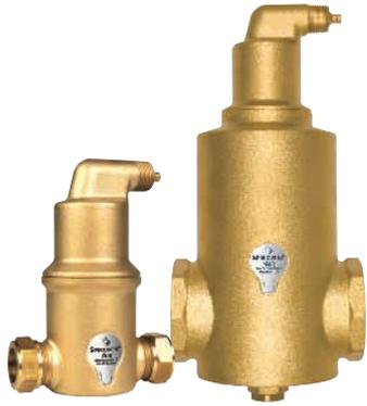
Modelos para montaje en tubería horizontal están disponibles con racores de conexión a presión de 22mm y conexiones hembra roscadas de 3/4" a 2" G.
