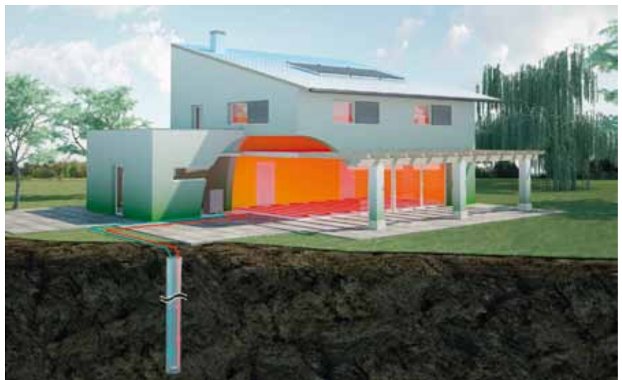
Recuperación de la energía del suelo mediante sondas verticales
