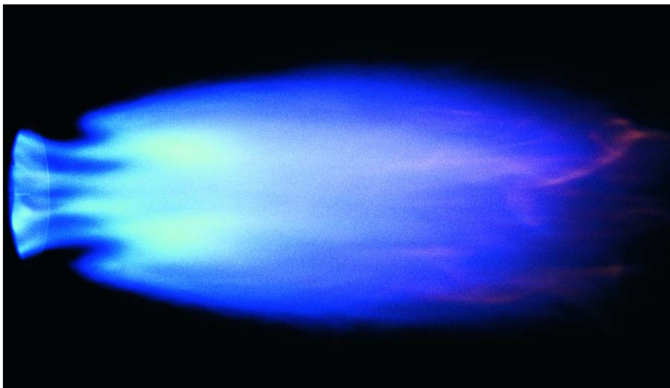
Imagen típica de la llama en los quemadores de gas en ejecución LN (LowNO x )
